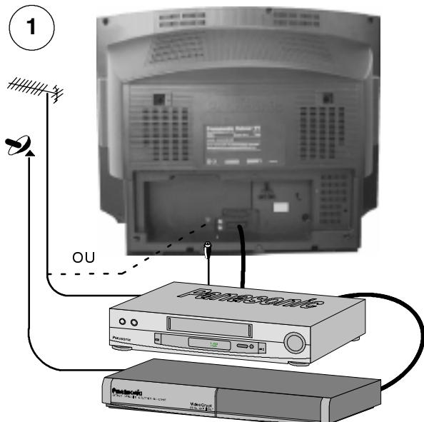
Raccordez l'antenne et branchez l'équipement auxiliaire.
